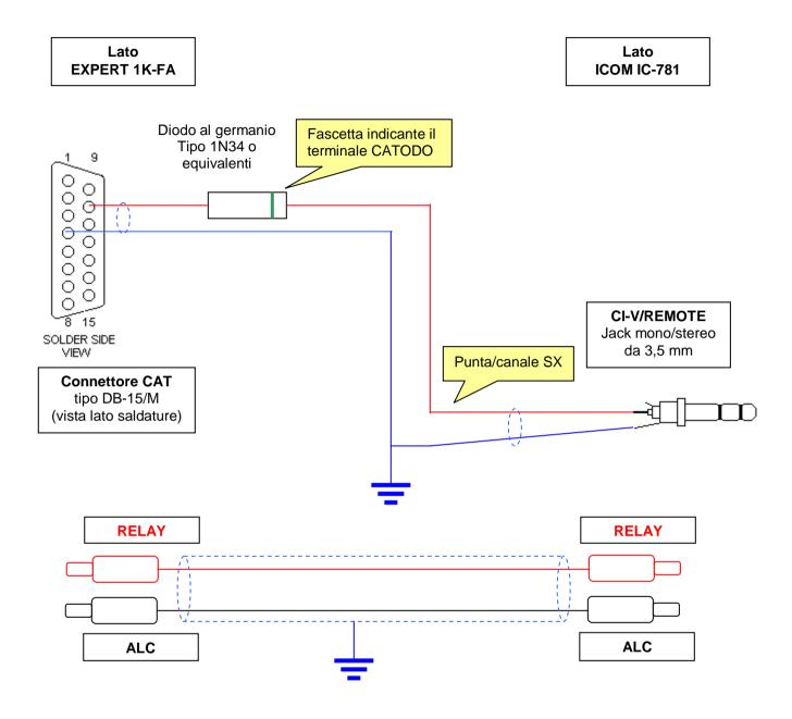
L'ICOM IC-781 può essere collegato al lineare EXPERT 1K-FA seguendo lo schema dei collegamenti come sopra riportato e senza alcun bisogno di interfacce esterne tipo ICOM CT-17 o similari (a meno che non si intenda gestire il ricetrasmettitore tramite computer ed apposito software).
