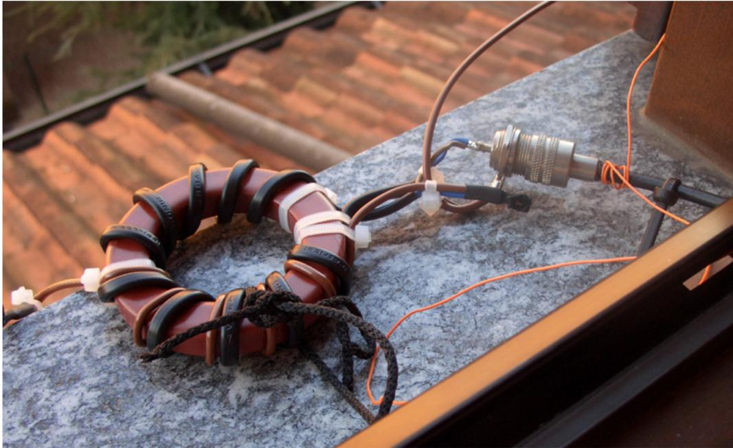
Questa è l'ultima antenna di fortuna che mi sono inventato, non avendo ancora pianificato l'installazione dell'antenna sul tetto, ho ripiegato momentaneamente sfruttando il vicino tetto del porticato sotto casa e per mimetizzare il tutto ho utilizzato un cavo elettrico ricoperto di colore marrone.
