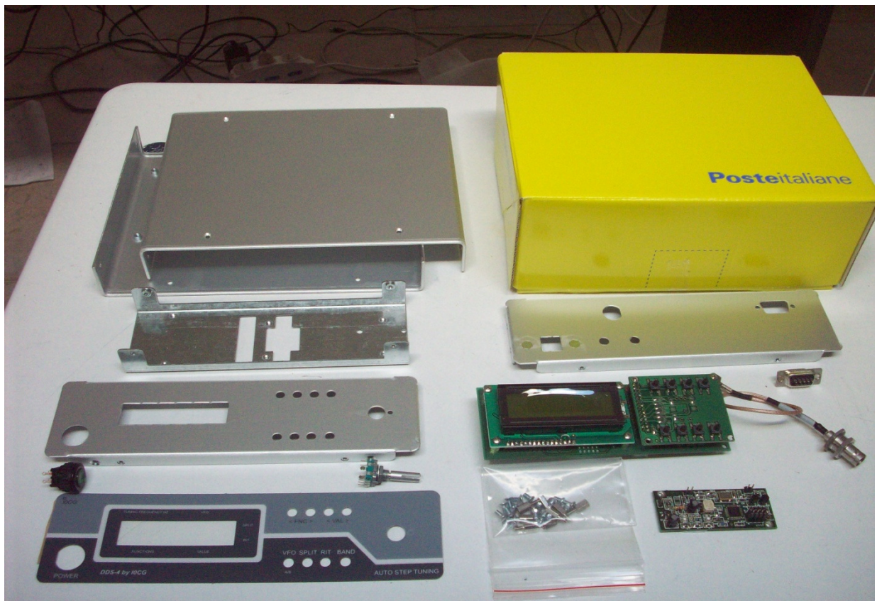
Kit completo di tutte le PCB della funzione TX digitale (SDT) (L'SDRx usa ulteriori 2 PCB)
