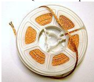
calza desolder wicks + esempio assorbimento stagno
